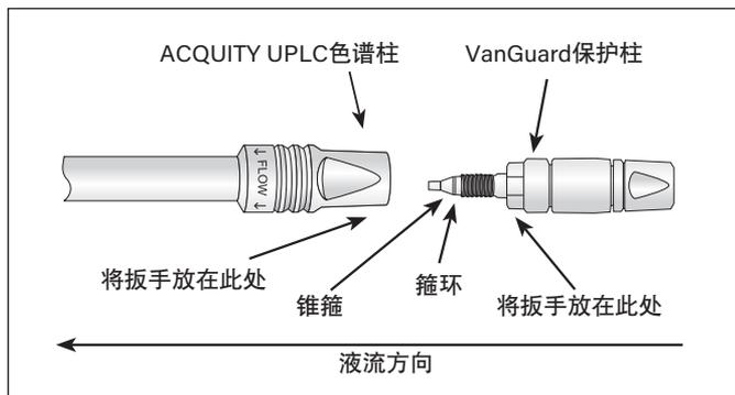
图1. VanGuard保护柱安装示意图。
