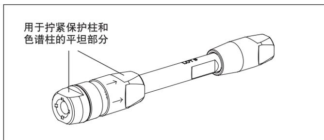
图2. 从ACQUITY Premier VanGuard FIT色谱柱上拆下VanGuard FIT保护柱时，放置3/8英寸扳手的推荐位置。
